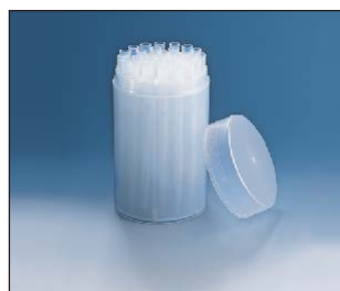
Tip-Box 5 a 10 ml špičky, je opakovane autoklávovateľný pri 121°C. Viečko musí byť pri autoklávaní mierne otvorené. 1 box obsahuje 28 špičiek.
